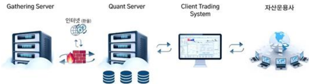
[그림 14] Quant Trading System 구조
